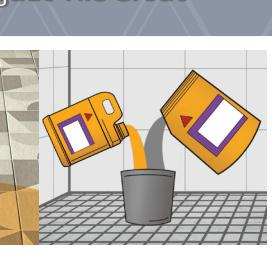
**FUNGSI**: Sebagai sambungan pengecoran antara beton lama dan beton baru, bahan tambahan aditif plasteran dinding dan lantai.
